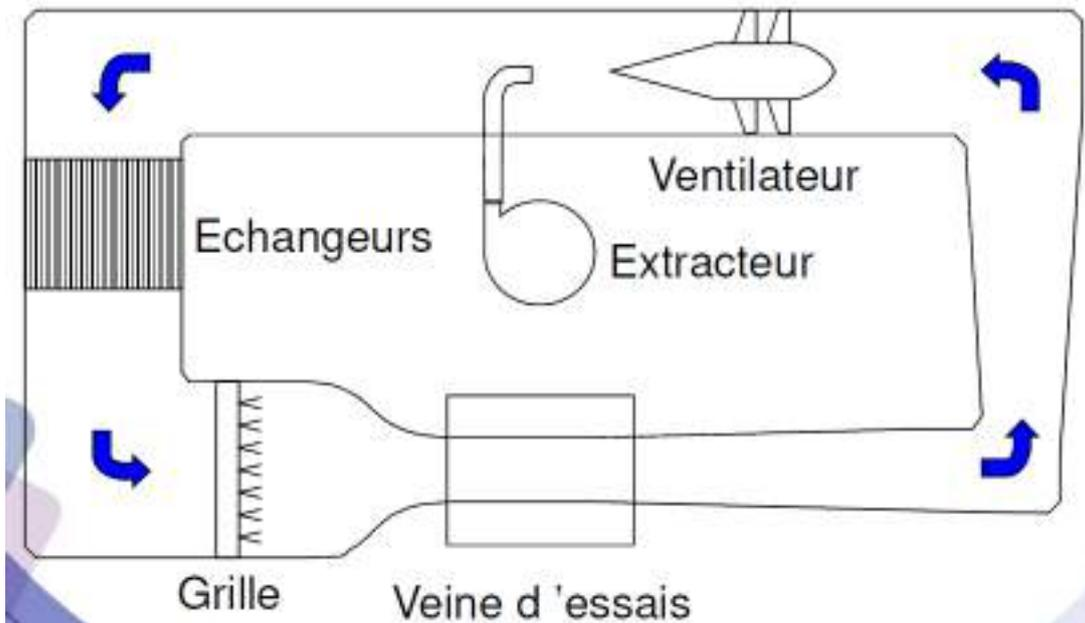
Figure 62 : Schéma de principe du banc d'essais PAG
