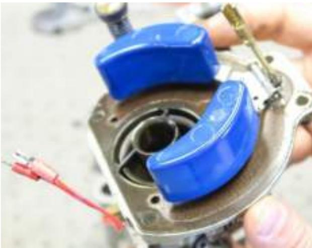
Figure 11 : Illustration des deux flotteurs associés par une pièce métallique
