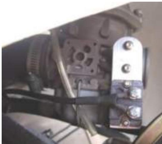
Figure 145 : Positionnement de résistance chauffante sur la surface extérieure du carburateur
