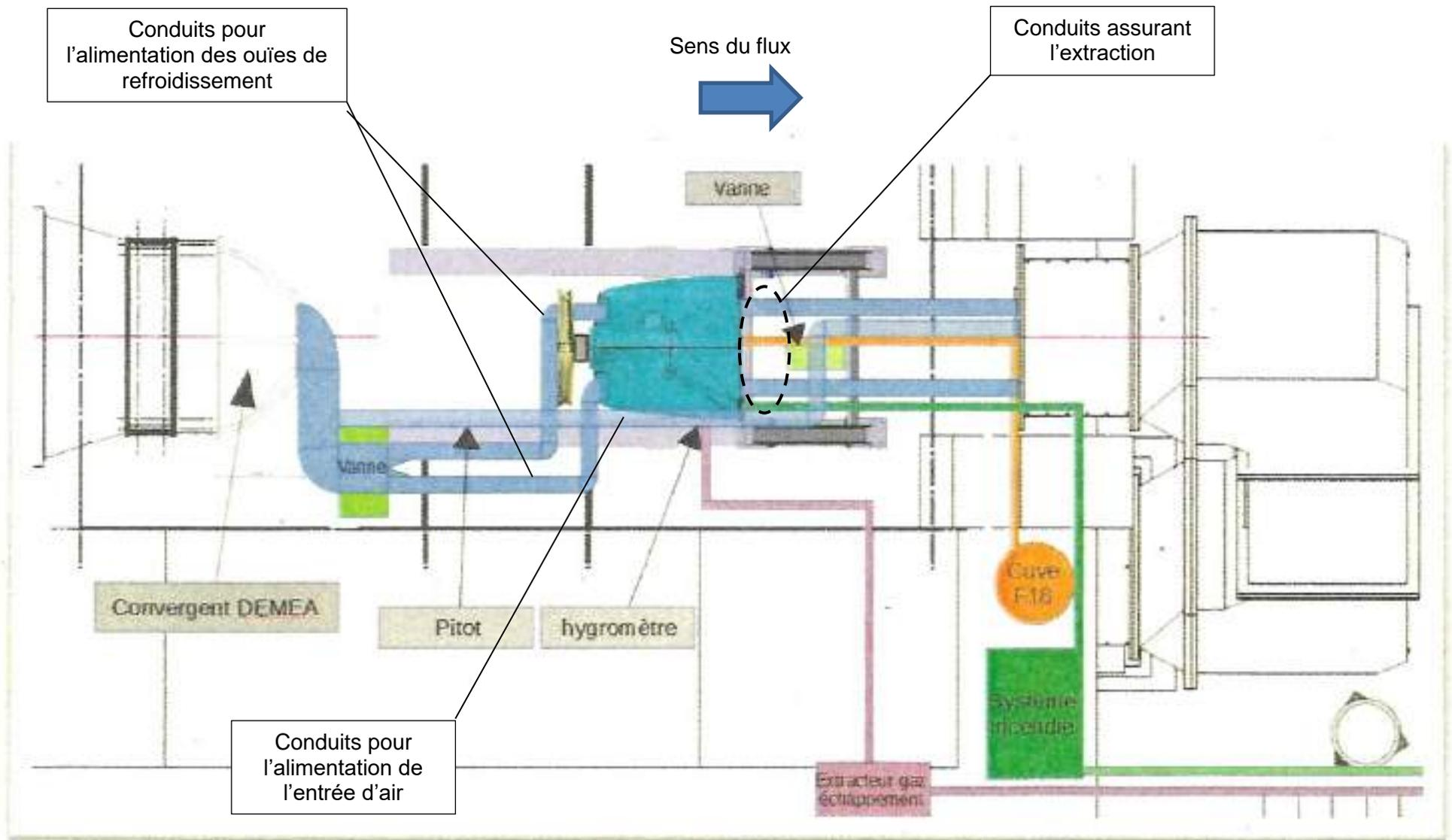
Figure 90 : Alimentation en air "conditionné" de l'installation motrice
