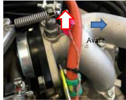
Figure 216 : Capteur de mesure de température
