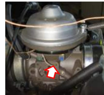
Figure 199 : Capteur de mesure de température
