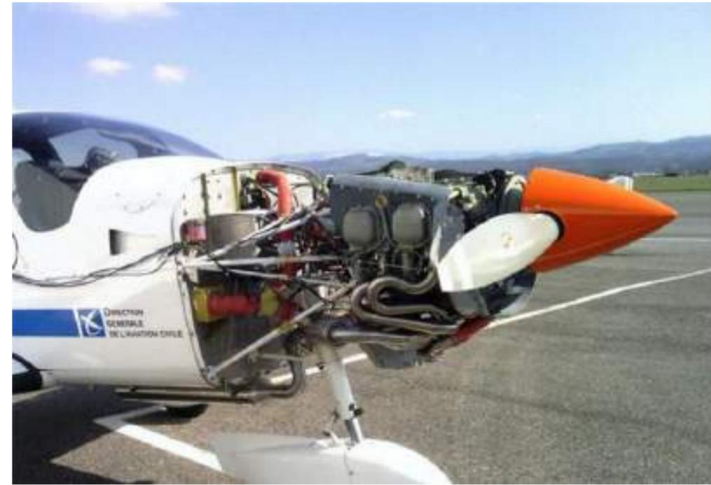
Figure 65 : Système propulsif de l'avion TB10
