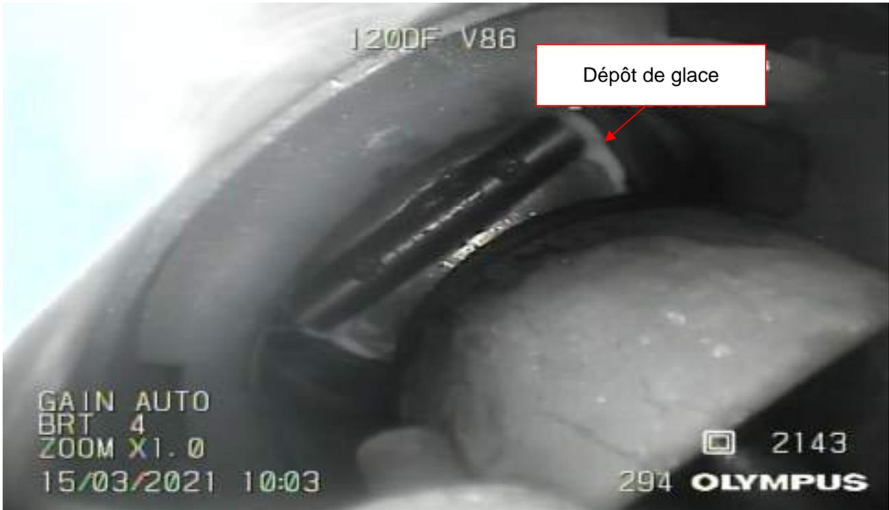
Figure 105 : Progression du phénomène de givrage => instant désigné  $t_{0+4min}$
