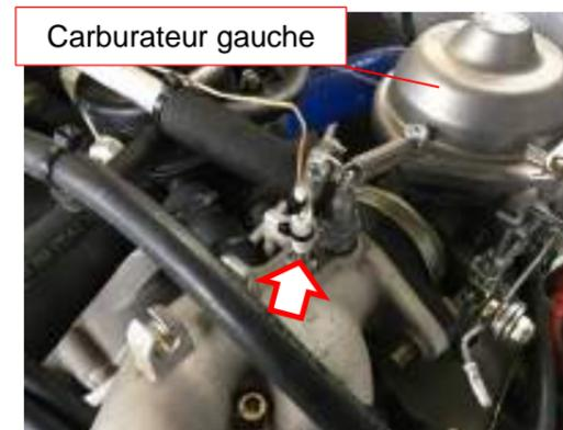
Figure 180 : Capteur température
