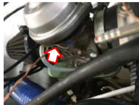
Figure 179 : Capteur température
