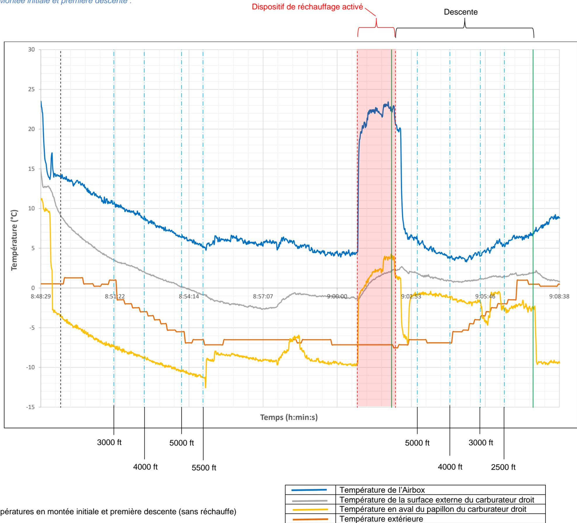
Figure 220 : Évolution des températures en montée initiale et première descente (sans réchauffe)
