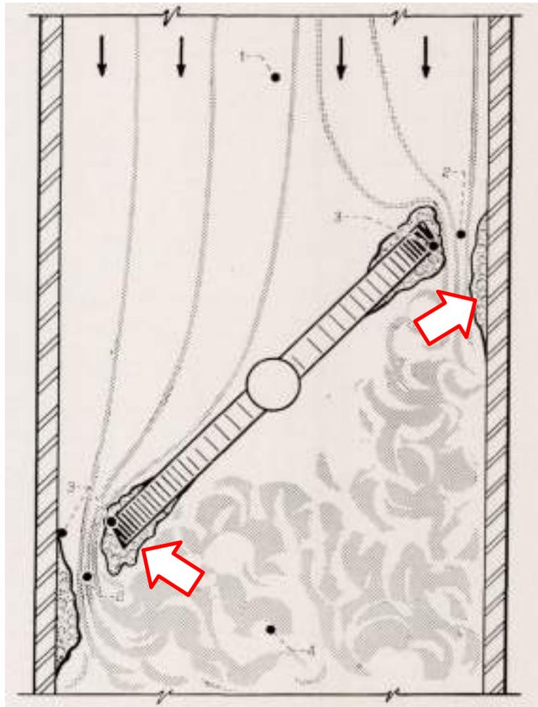
Figure 6 : Schéma illustrant le givrage carburateur
