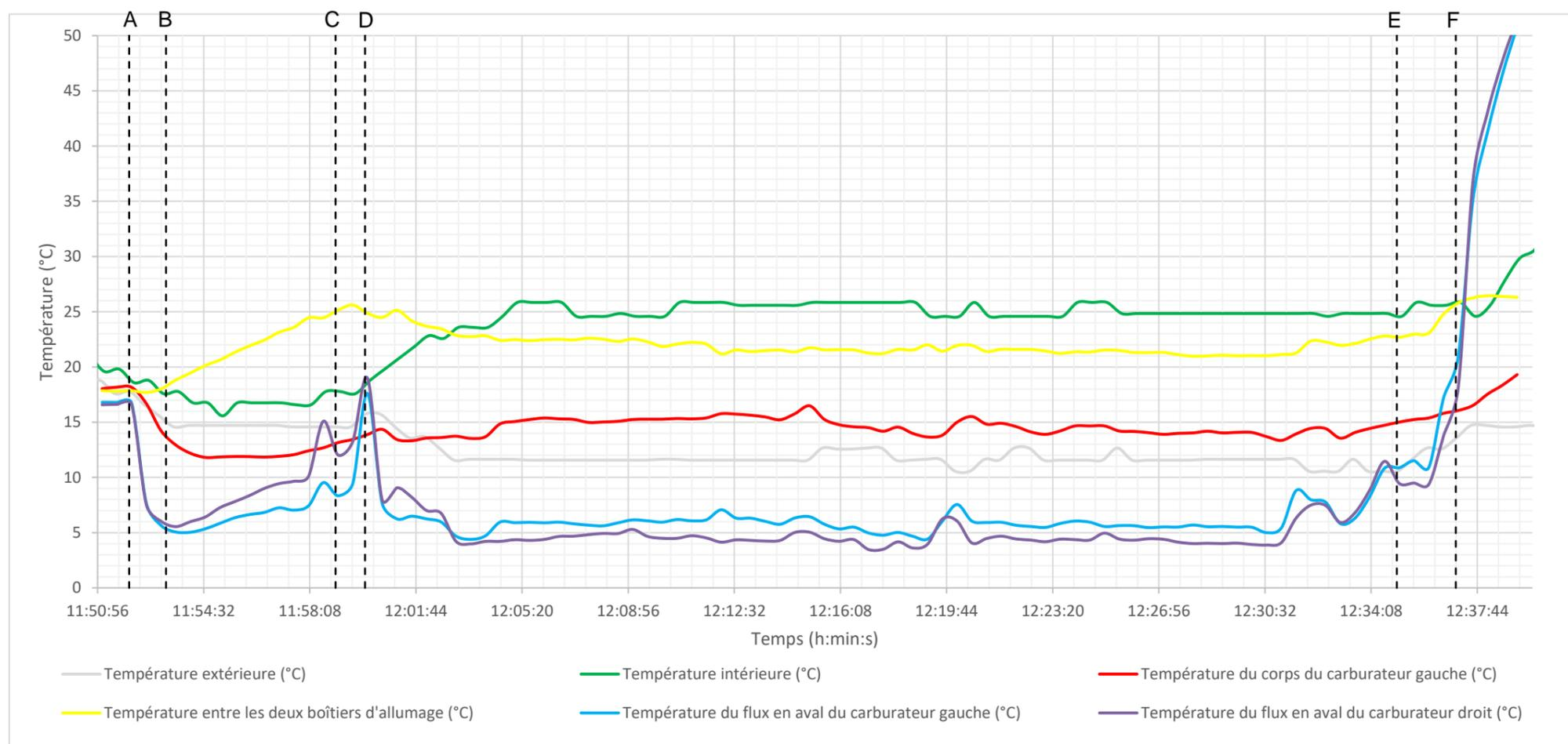
Figure 183 : Mesures de températures
