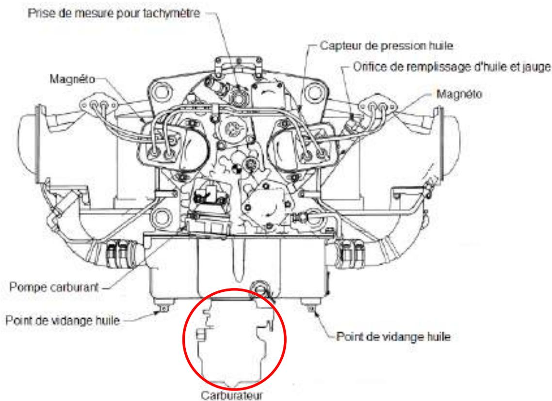
Figure 9 : Illustration de la position du carburateur sur un moteur Lycoming 0-360-A1AD
