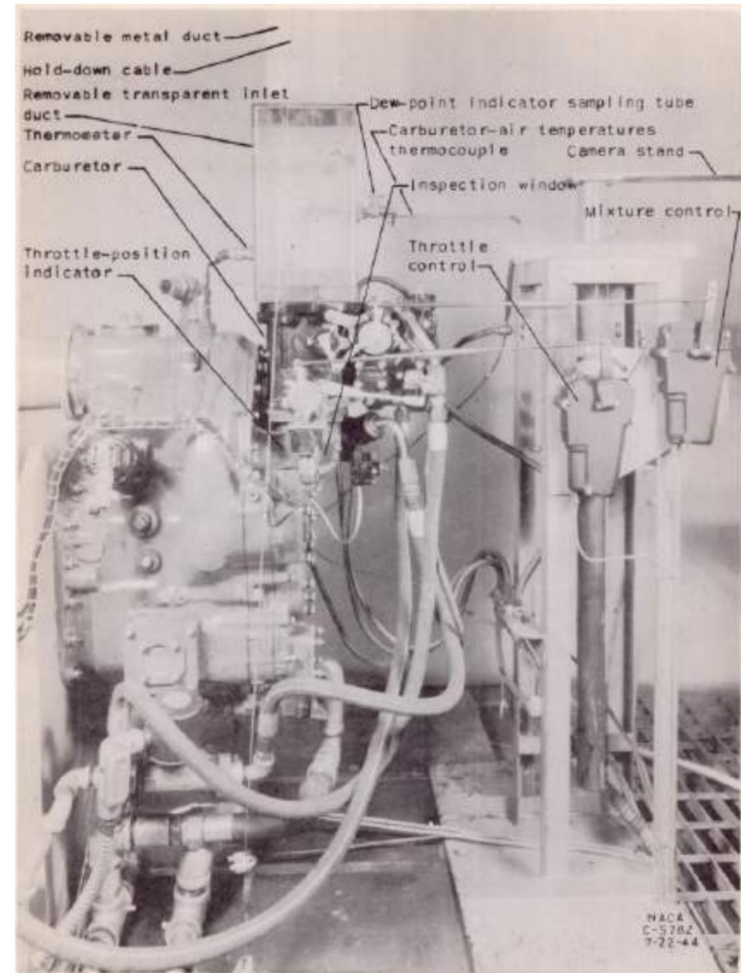
Figure 36 : Installation d'essais
