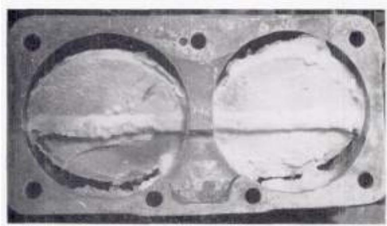
Figure 25 : Glace formée sur les vannes à papillon
