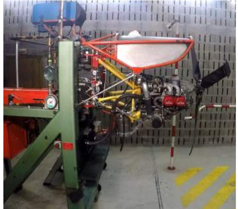
Figure 150 :Moteur Rotax 914 du BEA installé au banc d'essais de l'ENAC Castenaudary
