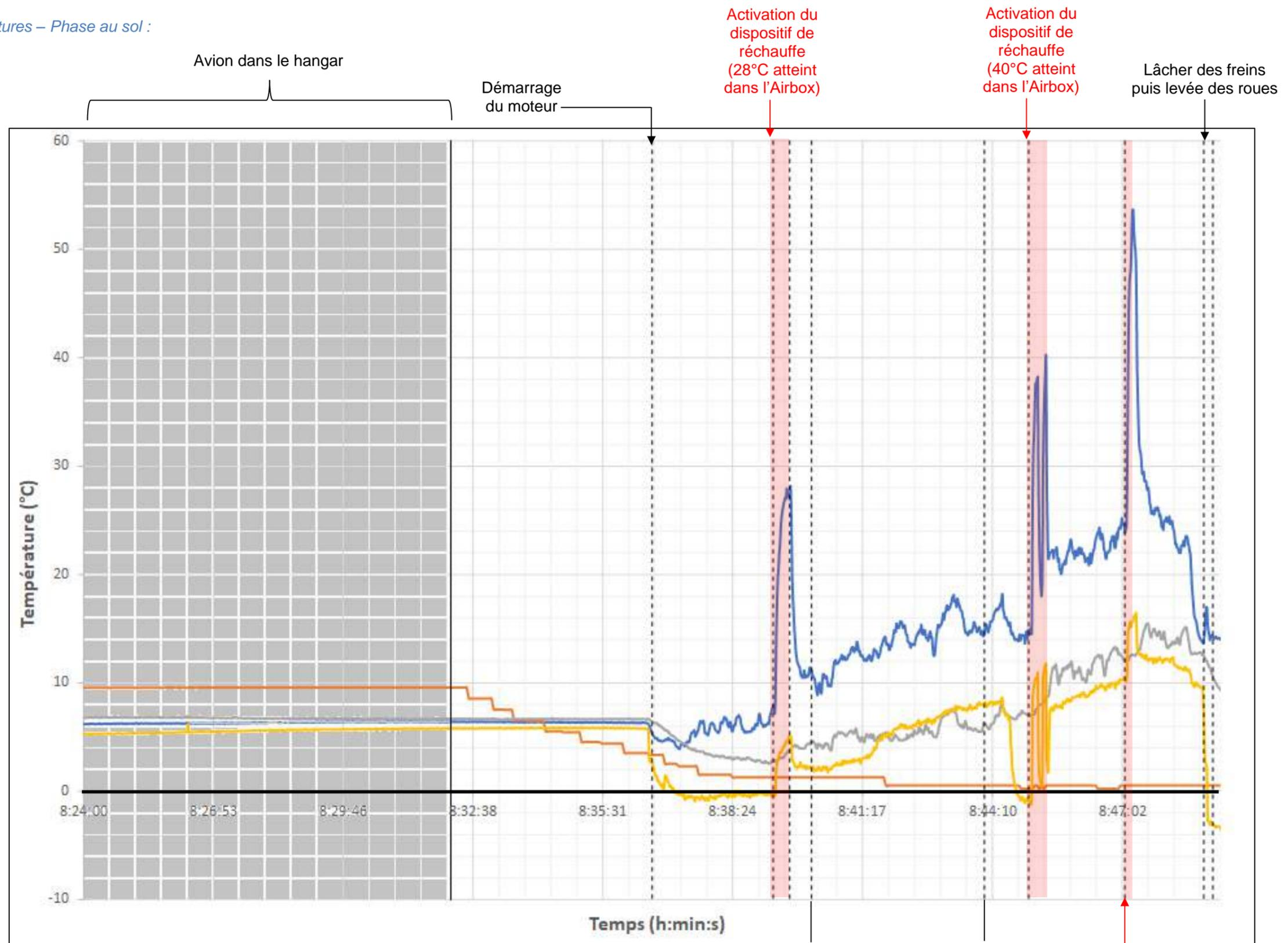
Figure 219 : Évolution des températures au sol
