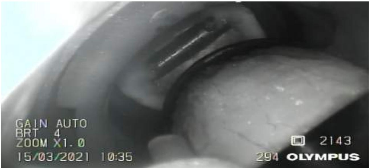
Figure 110 : Progression du phénomène de givrage => amorce de la phase 3 => instant désigné  $t_2$
