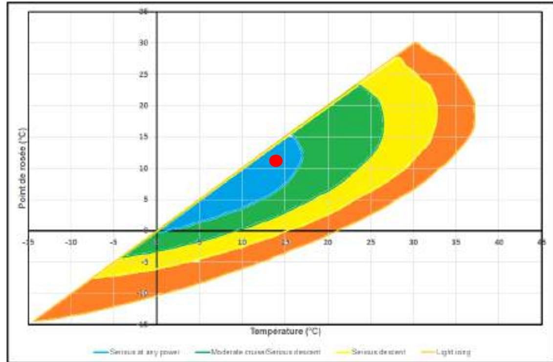
Figure 182 : Repositionnement des conditions météo dans le diagramme EASA
