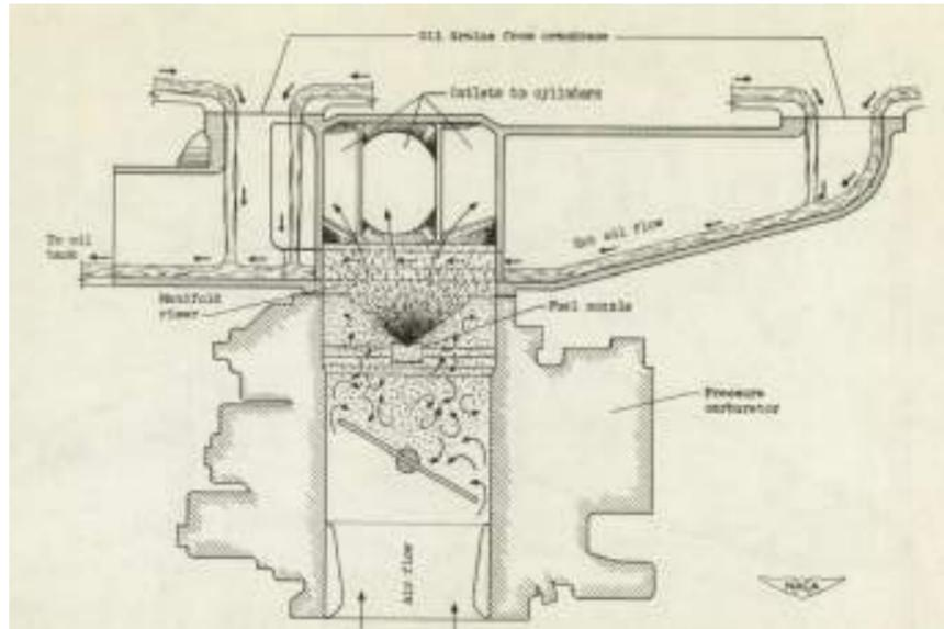
Figure 43 : Schéma du carburateur
