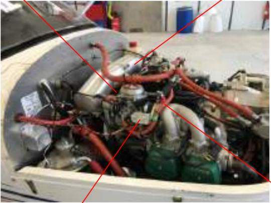
1 capteur iButton positionné sous les capots moteur, à proximité immédiate du carburateur gauche (mesure de température et d'humidité relative)
