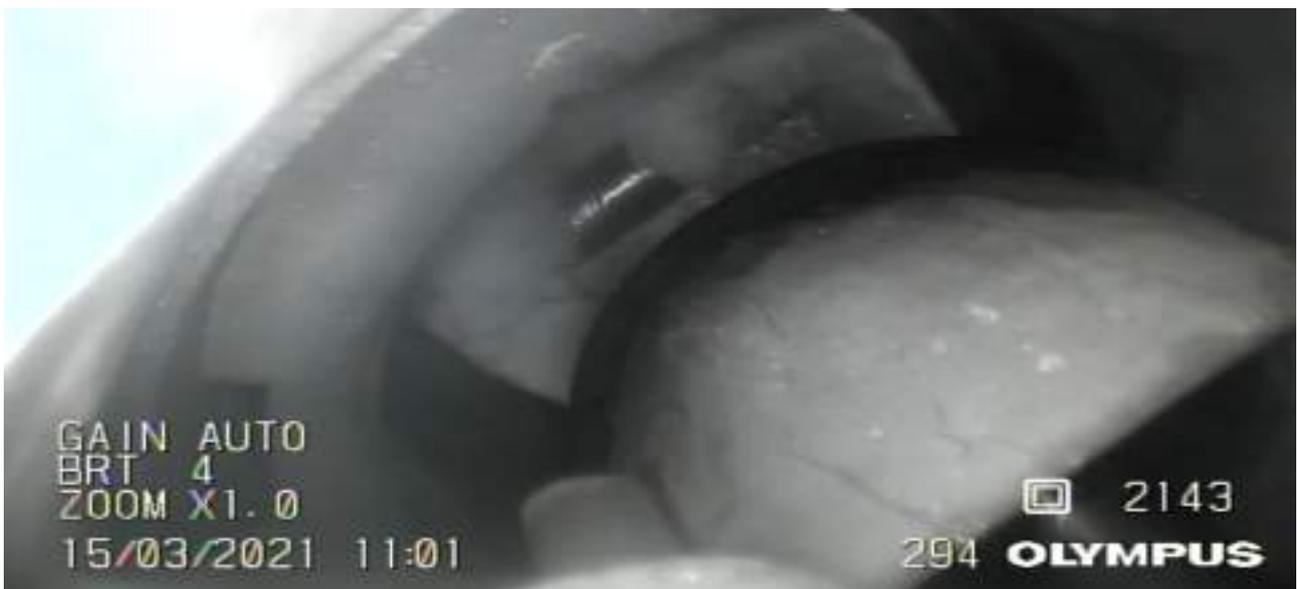
Figure 115 : Progression du phénomène de givrage => instant désigné  $t_{4+4\text{min}}$
