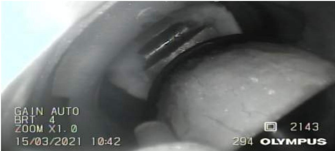
Figure 111 : Progression du phénomène de givrage => instant désigné  $t_2 + 7$  min
