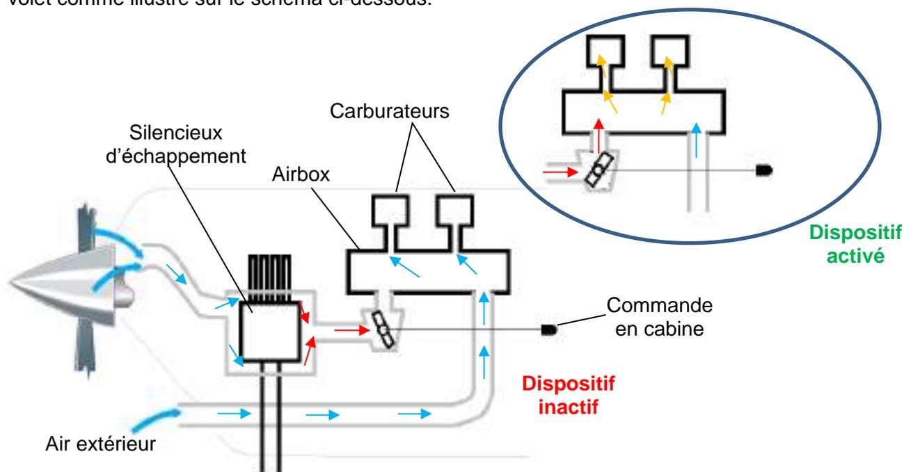
Figure 143 : Schéma de principe du dispositif
