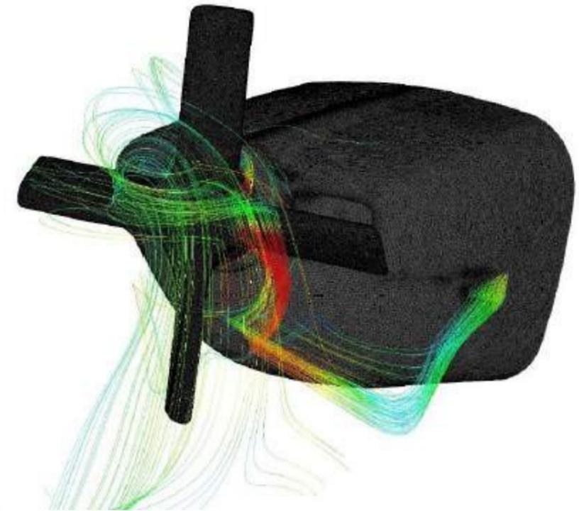
Figure 80 : Lignes de courant aspirées par le carburateur
