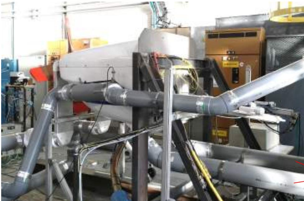
Conduits assurant l'extraction de l'air introduit à l'avant dans les capots moteurs
