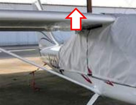
Figure 215 : Position du capteur de mesures de température et d'humidité relative
