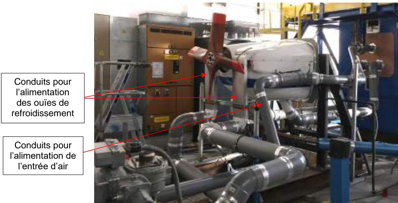
Figure 92 : Installation - vue de 3/4 avant droite
