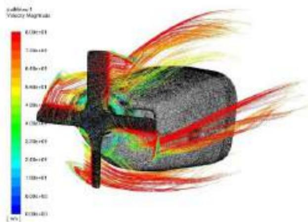
Figure 72 : Lignes de courant passant par l'hélice
