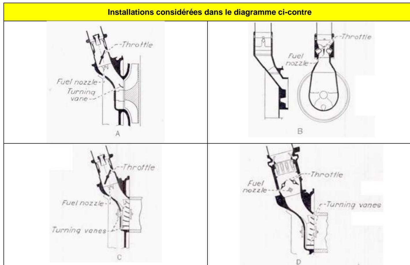
Figure 29 : Diagrammes définissant la limite du domaine de givrage sévère pour quatre types d'installations
