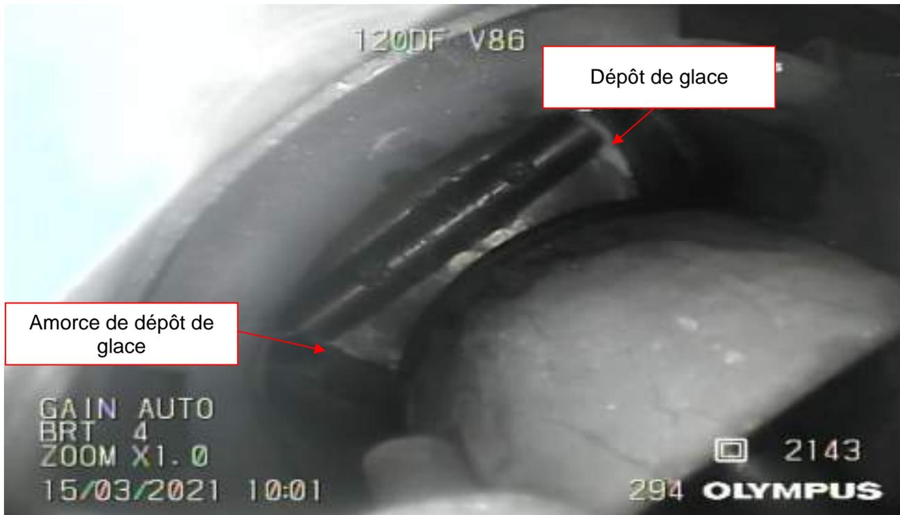
Figure 104 : Progression du phénomène de givrage => instant désigné  $t_0+2\text{min}$
