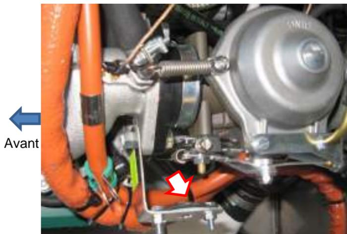
Figure 198 : Capteur de mesures de température et d'humidité relative
