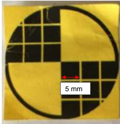
Figure 84 : Cible type collée sur plusieurs parties du moteur
