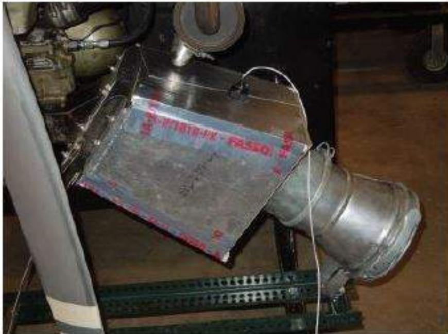
Figure 48 : Enceinte entourant le carburateur pour fournir les conditions de température et d'hygrométrie commandées
