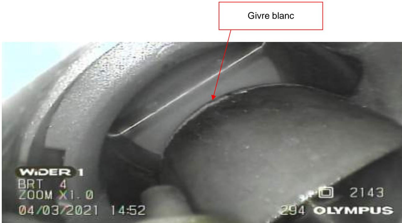
Figure 122 : Présence de givre blanc sur la surface extérieure du venturi
