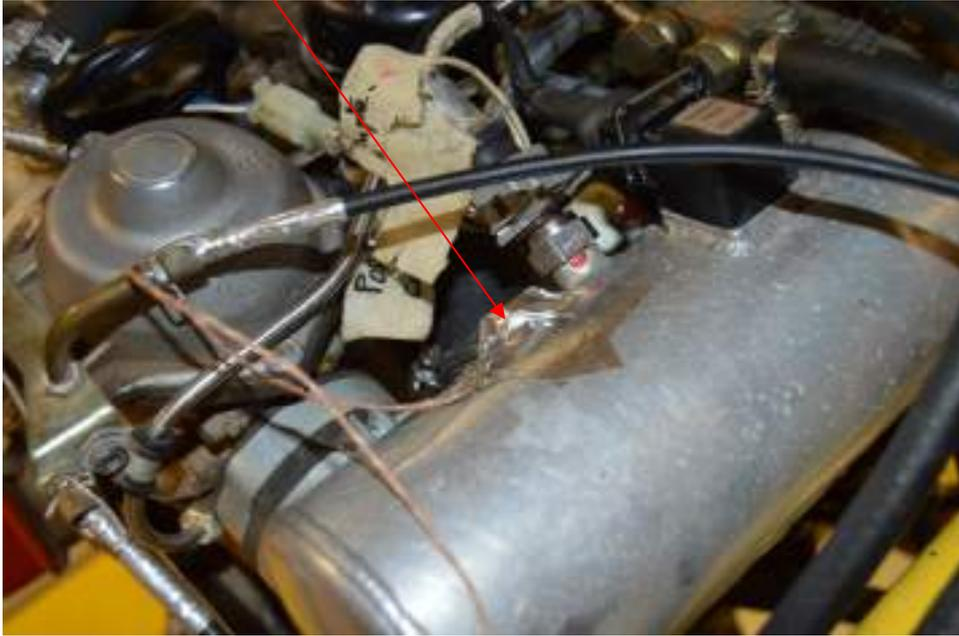
Figure 226 : Thermocouple dans l'Airbox
