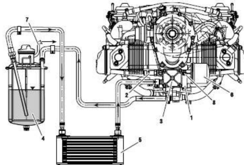
Figure 131 : Schéma du circuit de lubrification
