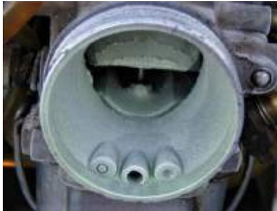
Figure 5 : Givrage d'un carburateur à dépression constante
