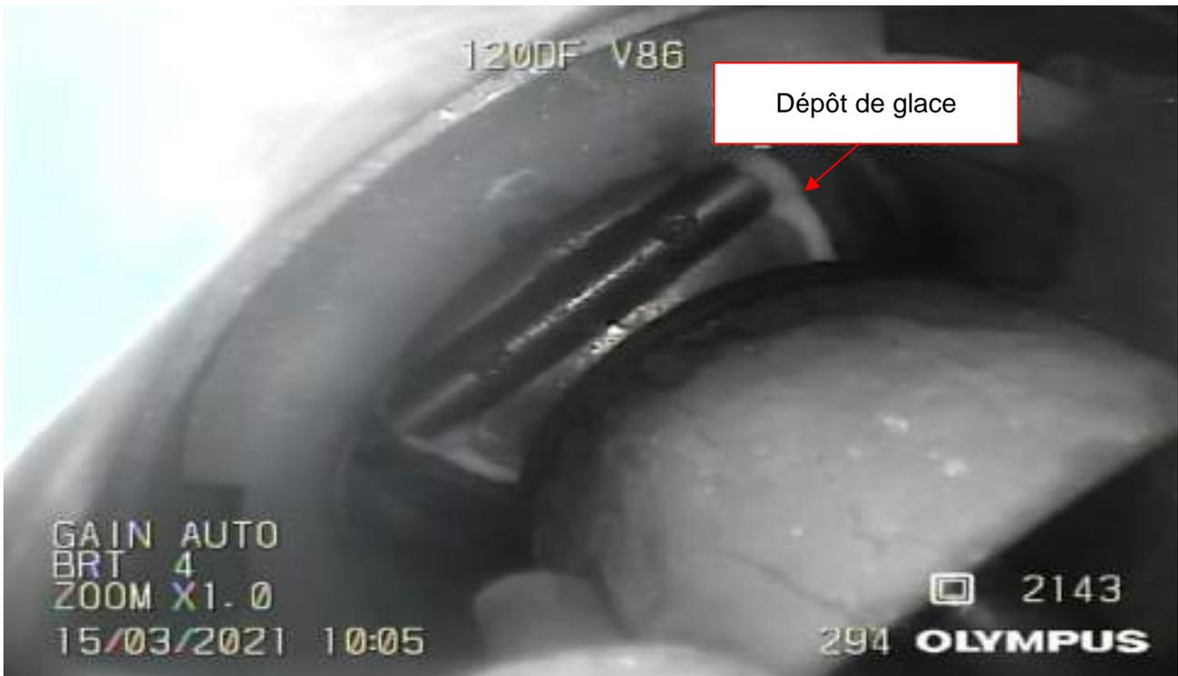
Figure 106 : Progression du phénomène de givrage => instant désigné  $t_0 + 5 \text{ min } 43 \text{ s}$
