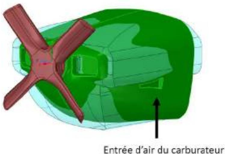
Figure 71 : Modèle obtenu après scannage de l'hélice et des capots
