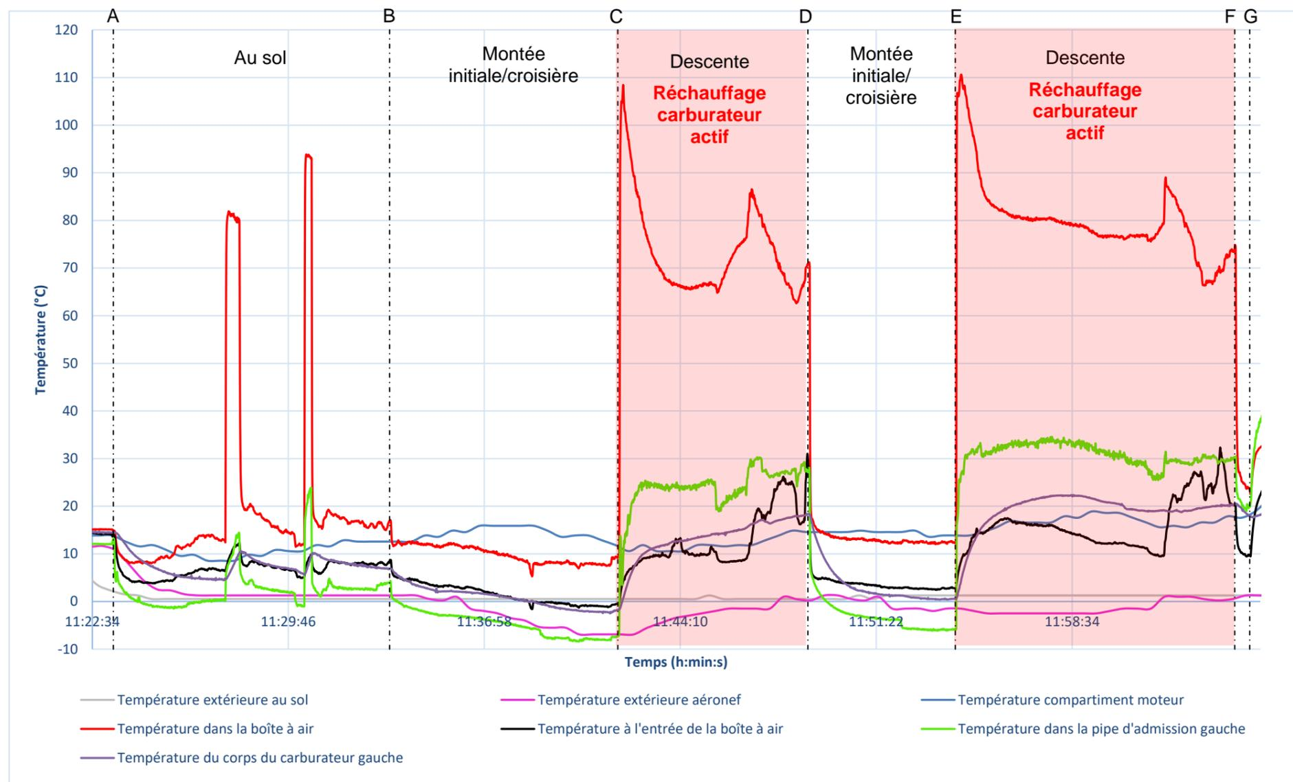
Figure 204 : Mesures de températures
