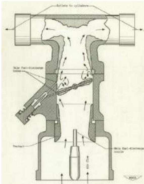
Figure 39 : Schéma du carburateur
