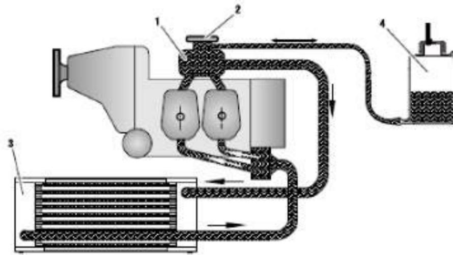
Figure 133 : Schéma du circuit de refroidissement
