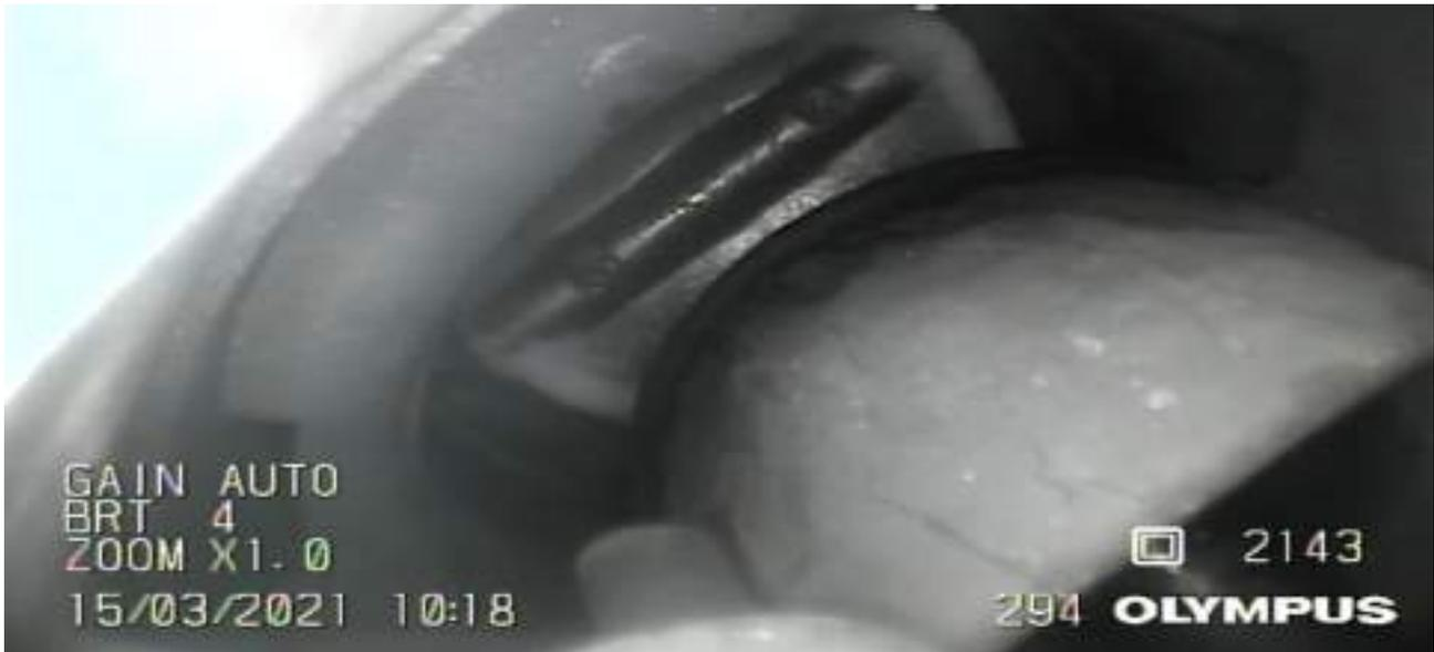
Figure 108 : Progression du phénomène de givrage => amorce de la phase 2 => instant désigné  $t_1$
