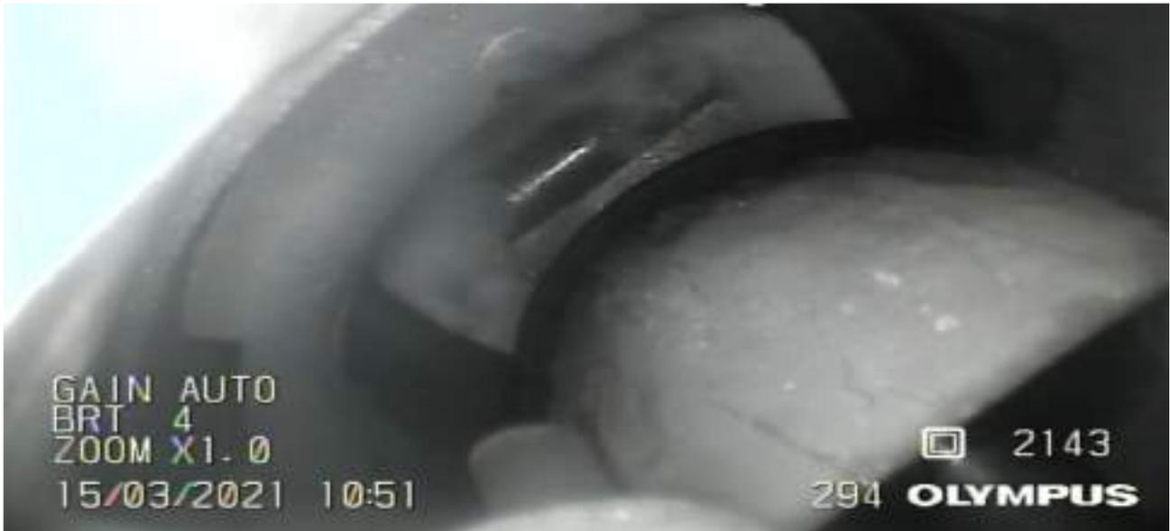
Figure 112 : Progression du phénomène de givrage => amorce de la phase 4 => instant désigné  $t_3$
