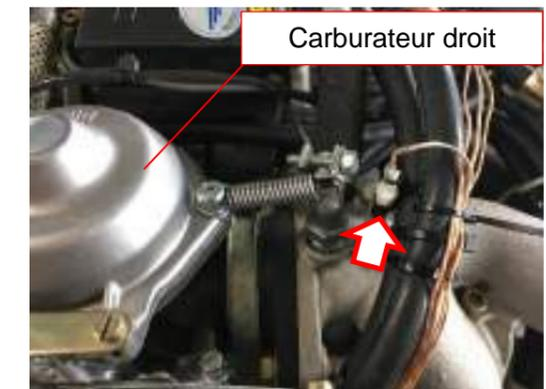
Figure 181 : Capteur température
