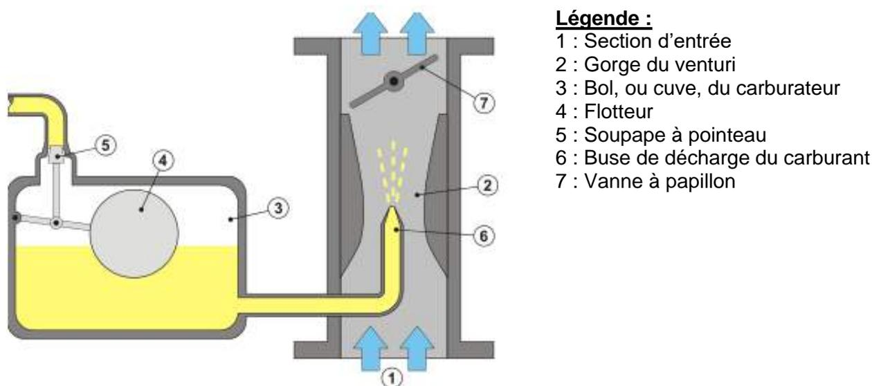
Figure 7 : Schéma de principe d'un carburateur à flotteurs
