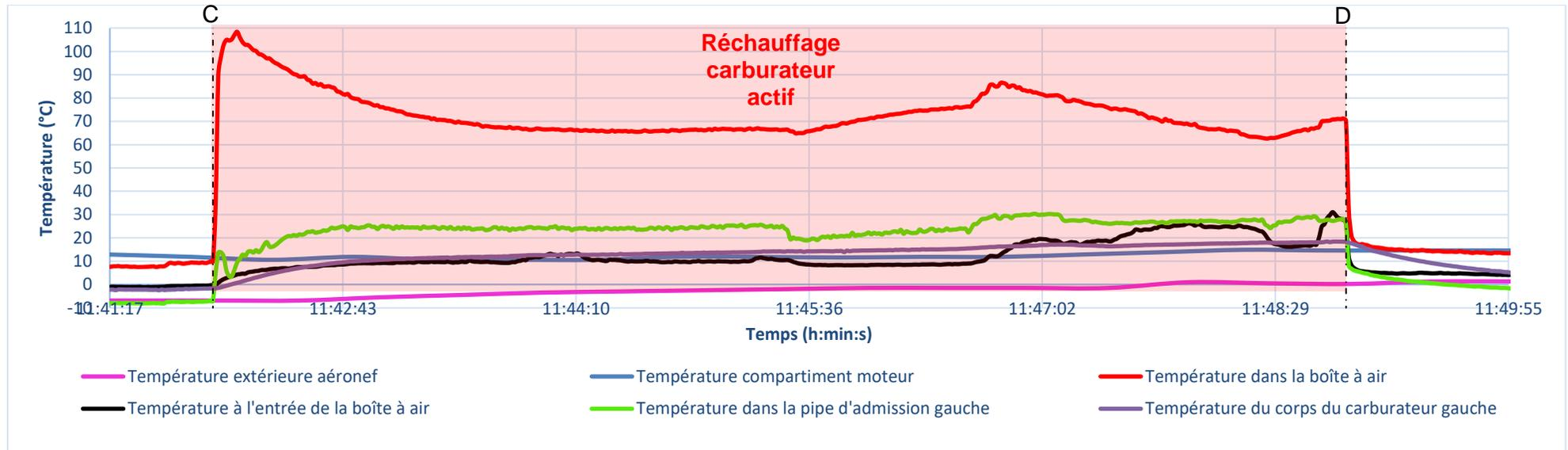
Figure 207 : Mesures de températures
