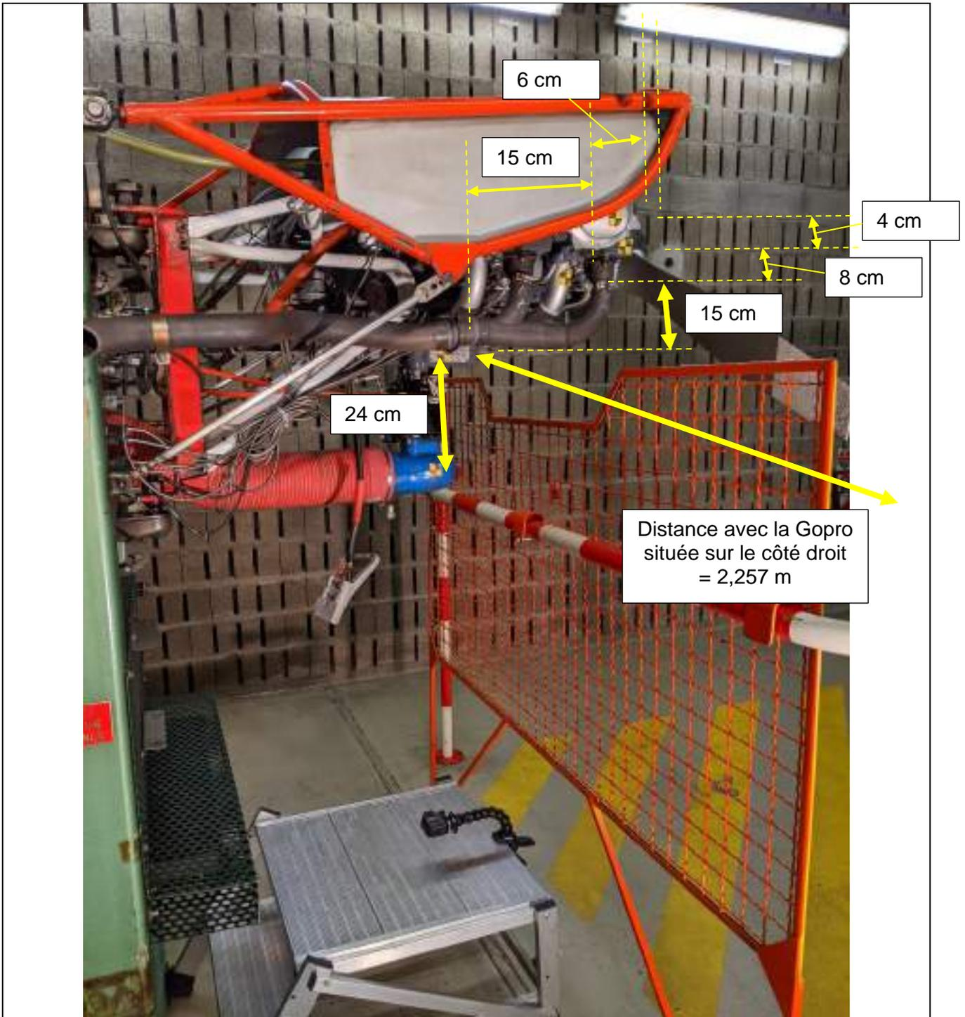
Figure 86 : Position de la GOPRO située sur le côté droit du moteur
