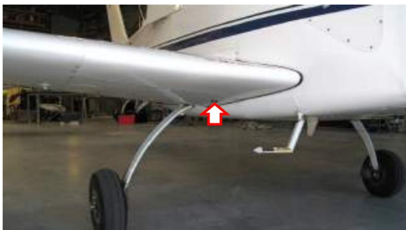
Figure 197 : Capteur de mesures de température et d'humidité relative
