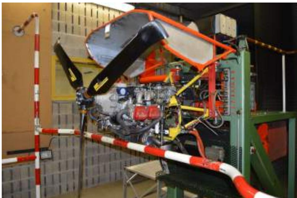
Figure 224 : Moteur Rotax 914 au banc d'essais
