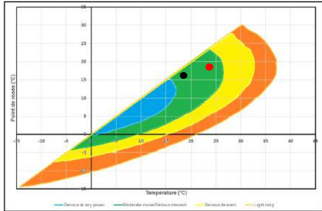
Figure 190 : Repositionnement des conditions météo dans le diagramme EASA
