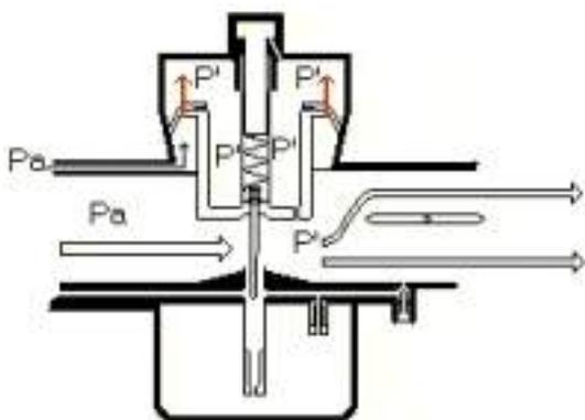
Ce type de carburateur est équipé d'un boisseau qui coulisse dans un logement et permet d'obstruer plus ou moins le flux d'air. La vanne à papillon permet de régler l'ouverture du boisseau, grâce à la plus ou moins grande dépression du moteur. Avec une faible ouverture de la vanne à papillon, le boisseau reste en position basse. À pleine ouverture de la vanne à papillon, le boisseau se soulève, le ressort de rappel aidant à le maintenir en position haute.
