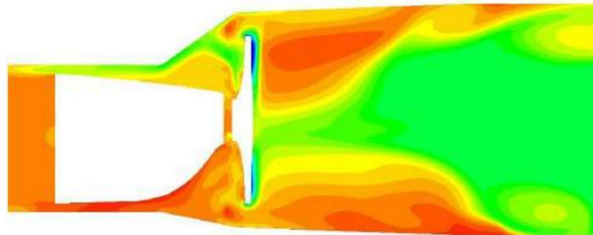
Figure 81 : Élévations de température induites par les recirculations
