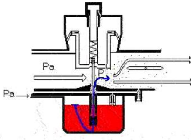
Figure 16 : Schéma de principe de l'injection carburant
