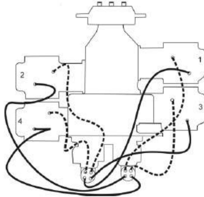
Figure 70 : Schéma de principe du circuit d'allumage
