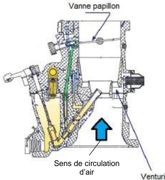
Figure 13 : Schéma en coupe du carburateur
