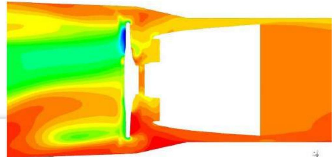
Figure 82 : Élévations de température induites par les recirculations
