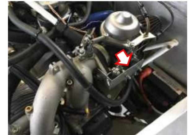
Figure 177 : Capteur température/humidité relative
