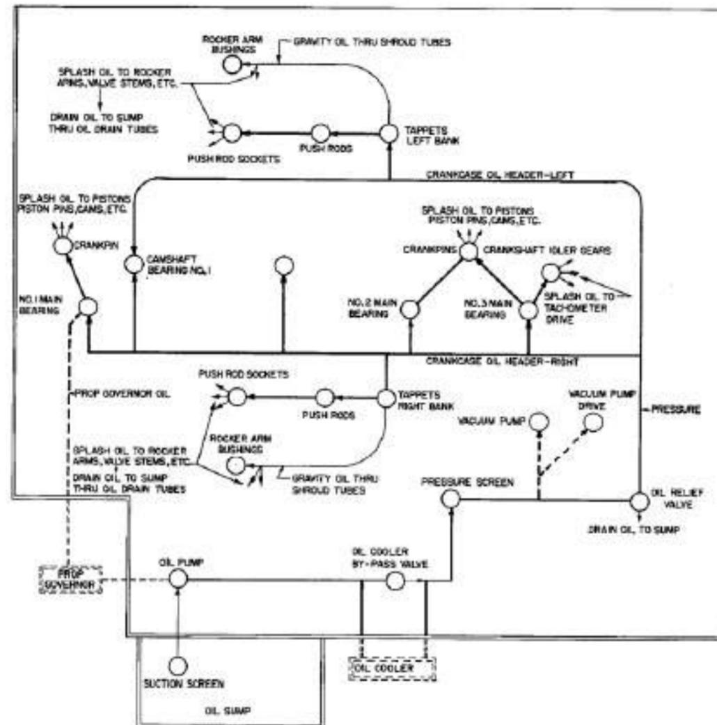
Figure 69 : Schéma de principe du circuit de lubrification
