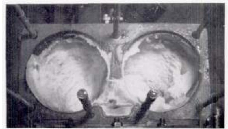
Figure 26 : Glace formée sur les collecteurs en aval des vannes à papillon
