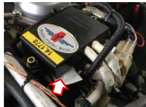
Figure 178 : Capteur température
