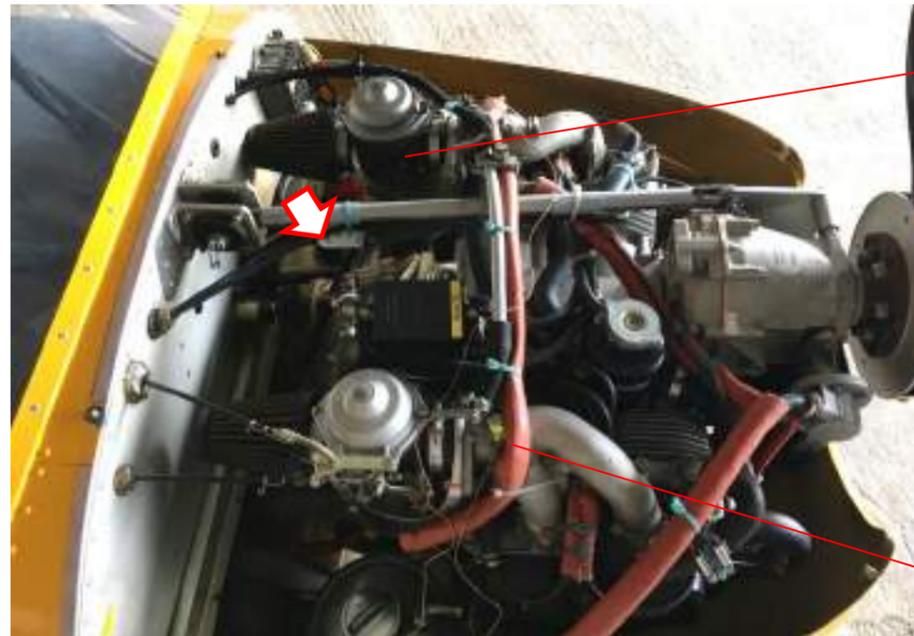
Figure 187 : Capteur température/humidité relative
