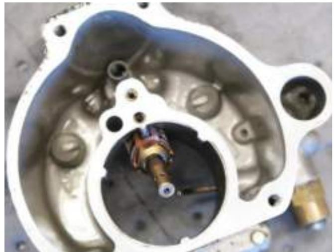
Figure 12 : Bol ou cuve du carburateur
