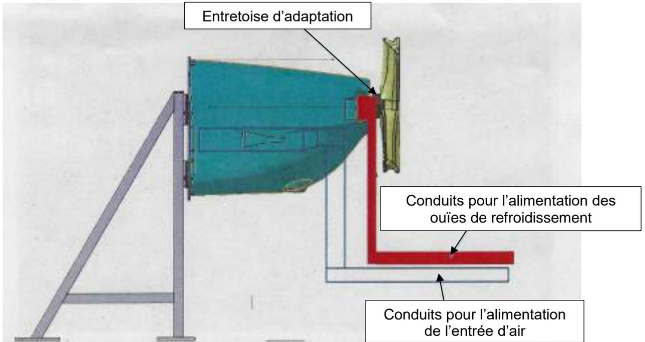
Figure 91 : Détail de l'installation
