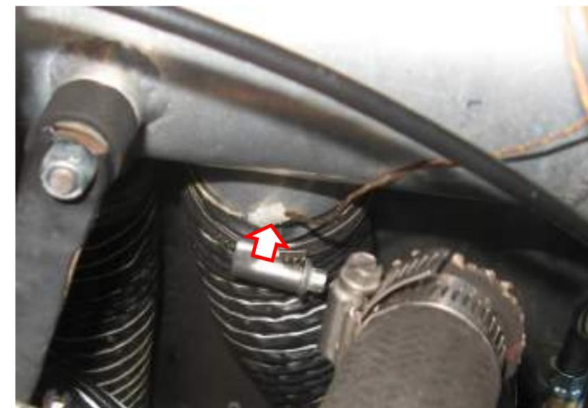
Figure 202 : Capteur de mesure de température
