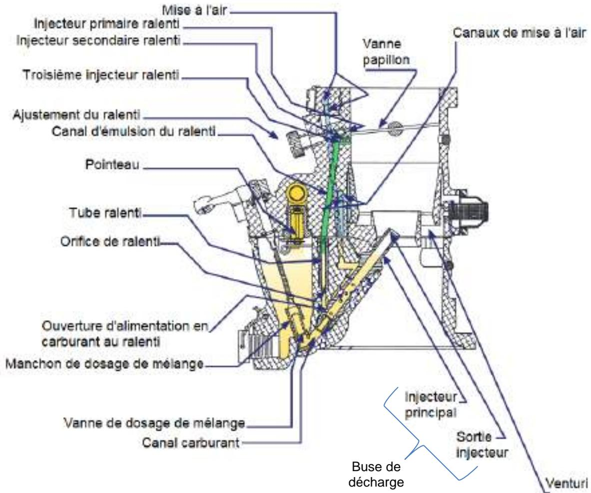
Figure 14 : Schéma en coupe du carburateur
