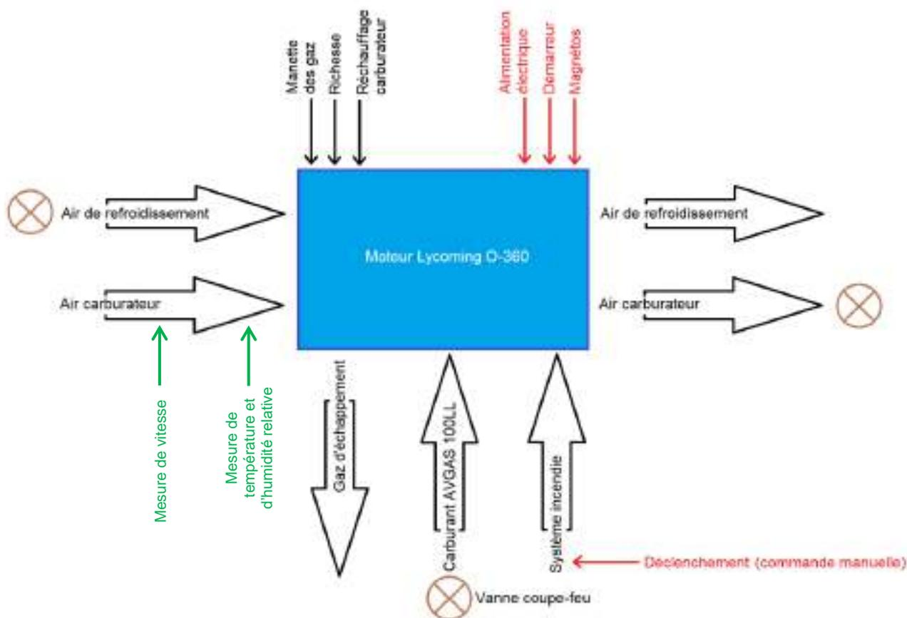
Figure 95 : Schéma de principe du montage
