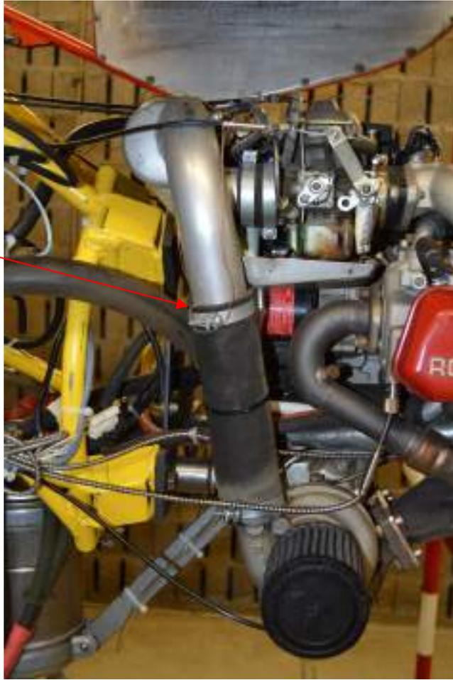
Figure 227 : Thermocouple entre le turbocompresseur et l'Airbox
