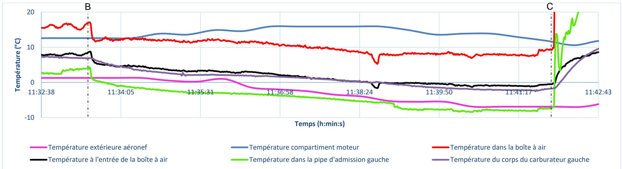
Figure 206 : Mesures de températures
