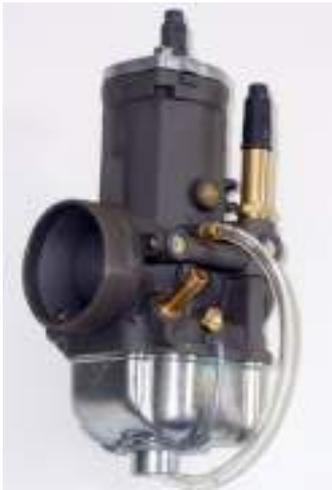
Figure 148 : Vue extérieure d'un carburateur Bing 54
