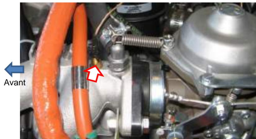
Figure 200 : Capteur de mesure de température
