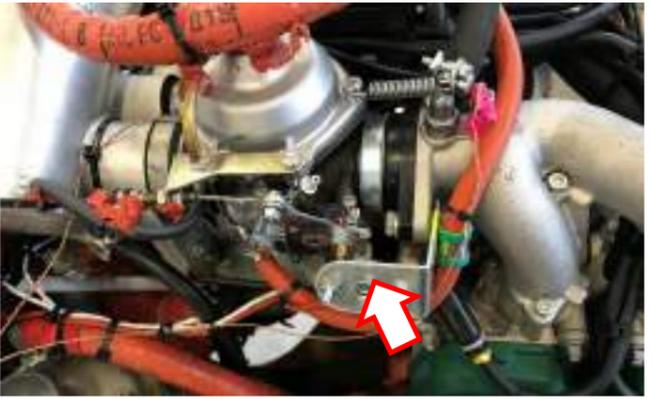
Figure 217 : Capteur de mesures de température et d'humidité relative
