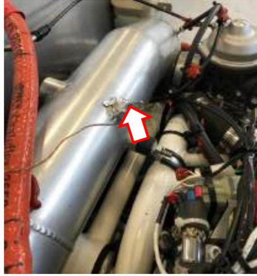
Figure 214 : Capteur de mesure de température
