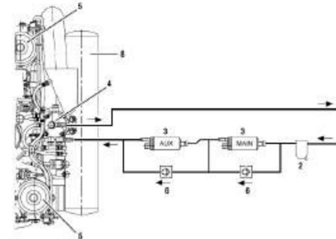
Figure 130 : Schéma du circuit carburant
