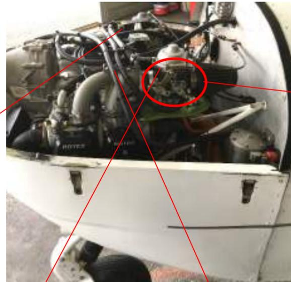
1 capteur iButton positionné sous les capots moteur, à proximité immédiate du carburateur gauche (mesure de température et d'humidité relative)
